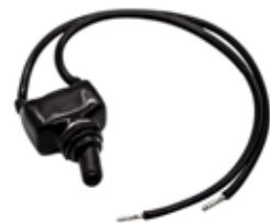
VINYL DIPPED SWITCHES 9427-11 - SPST - 12V 25A 9428-11 - SPDT - 25A 12V / 12A 24V 9429-11 - MOM SPDT - 25A 12V / 12A 24V
